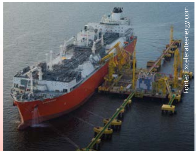
Exemplo de FSRU em operação, atracado em terminal de GNL com pier tipo ilha
